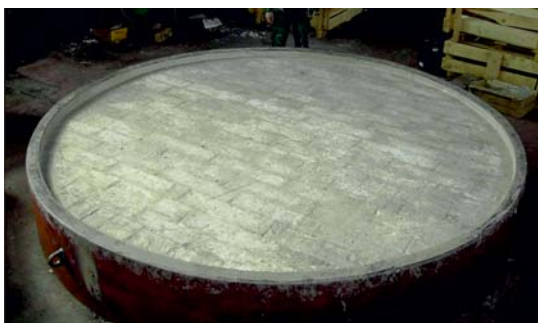
Рис. 7. Футеровка крышки электропечи ОКБ-827 (ЗАО «Завод Киров-Энергомаш», Санкт-Петербург)
