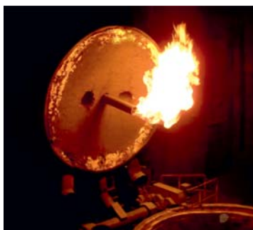
Рис. 8. Крышка стэнда разогрева сталеразливочных ковшей в работе («МЕЧЕЛ», Челябинский металлургический комбинат, ЭСПЦ-6)
