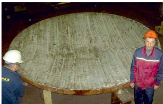
Рис. 5. Крышка шахтной термической печи, футерованная войлоком («мокрым») («ЕВРАЗ», колесо-бандажный цех НТМК)
