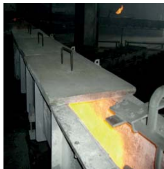
Рис. 6. Крышки желоба для передачи расплава алюминия (ООО «МордовВторСырье», г. Саранск)
