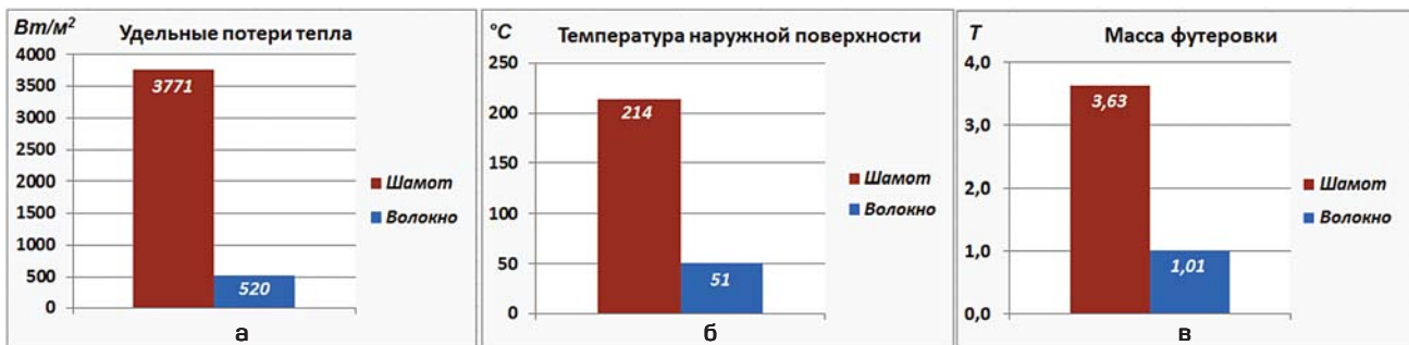
Рис. 2. Сравнительные показатели работы футеровки из шамотного кирпича и волокнистого огнеупорного материала ВР-350 (расчеты выполнены для рабочей температуры печи 950°C)
