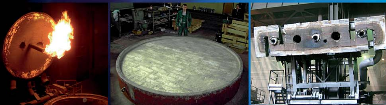
Футеровка крышек тепловых агрегатов
