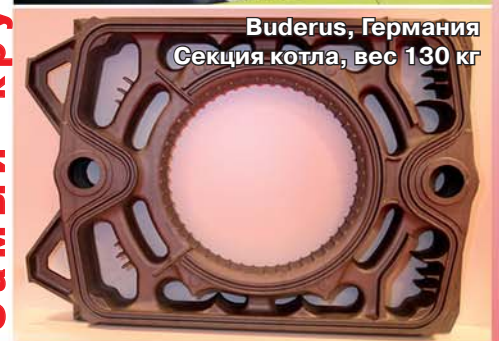
Сейатцу-процесс Завод Vuderus, Германия
