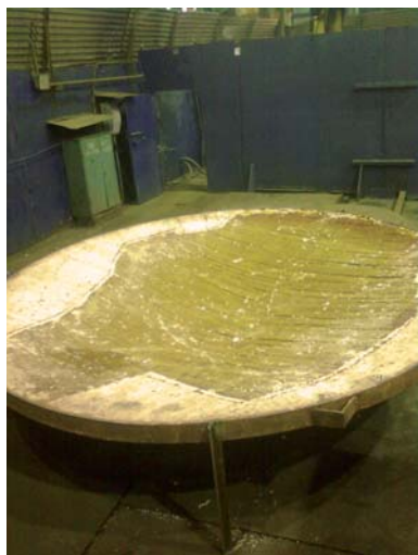
Рис. 3. Локальный ремонт крышки шахтной термической печи, футерованной «мокрым» войлоком
