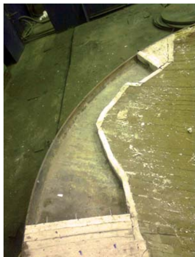
Рис. 3. Локальный ремонт крышки шахтной термической печи, футерованной «мокрым» войлоком
