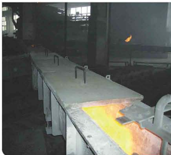
Фото 3. Крышки желоба для передачи расплава алюминия (ООО "МордовВтор Сырье", г. Саранск). Gutter's cover ("Mordovtorsyrie", Saransk.
