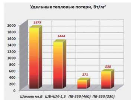
Рис. 1. Результаты аналитического расчета футеровки из различных материалов выполненного по оригинальной методике фирмы.
