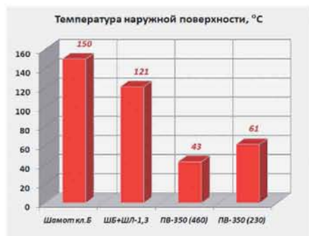
Рис. 1. Результаты аналитического расчета футеровки из различных материалов выполненного по оригинальной методике фирмы.
