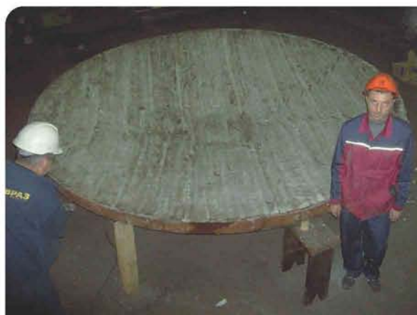
Фото 2. Крышка шахтной термической печи, («ЕВРАЗ НТМК») Lining of shaft furnace's cover (Wheel and tire shop «EVRAZ NTMK»).
